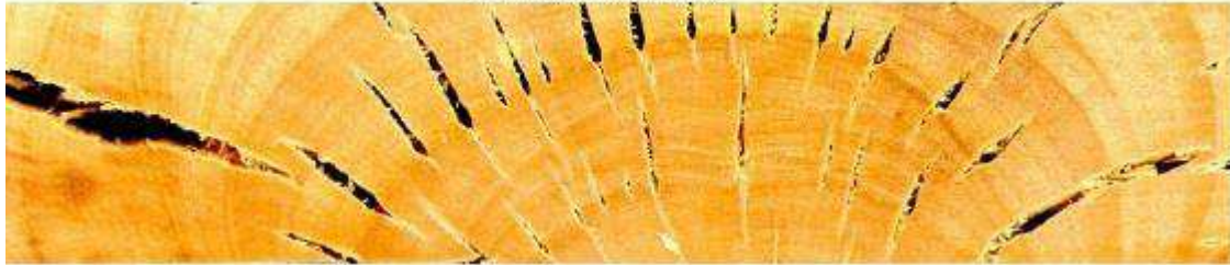
Fendas de heladura
