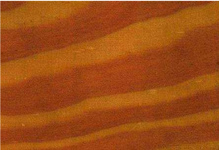
sección de un corte transversal de un árbol con madera de compresión.
